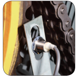
速度监控装置 Speed detector
